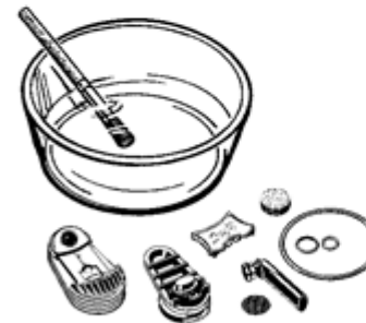
Ruční čištění rozložené chladicí jednotky
