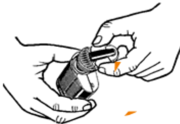
Demontáž chladičí jednotky (s náustkem)
