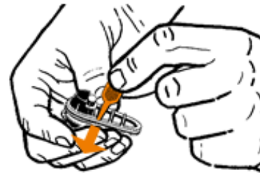
Odstranění velkého těsnění
