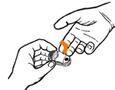
Otevření víčka krytu chladicí jednotky
