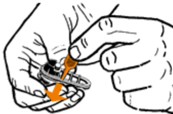
Demontáž velkého těsnícího kroužku
