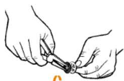
6. Odšroubujte matici z vrchního krytu plnicí komory
