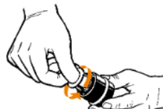
9. Odšroubujte válec plnicí komory
